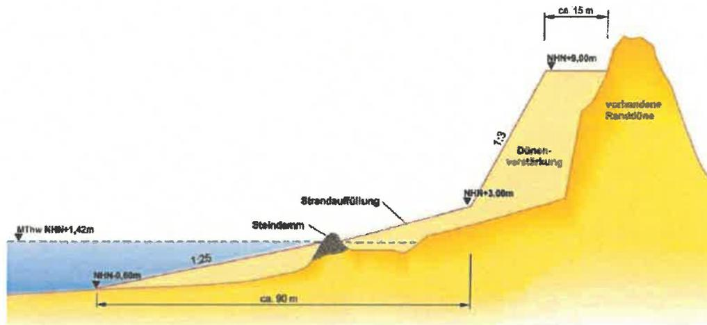
Abb.: Skizze Querschnitt Strandauffüllung
